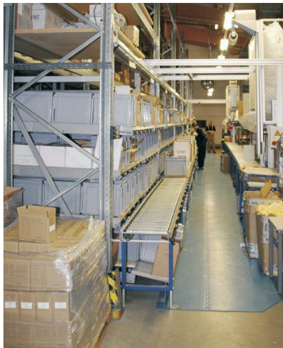
Pick-by-Light-Regalzeile mit Rollenfördertechnik, die die vier Kommissionierzonen verbindet
