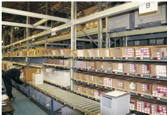
Hans-Conzen-Mitarbeiter beim Kommissionieren; das Pick-by-Light-System sorgt für weniger Fehler und mehr Durchsatz
