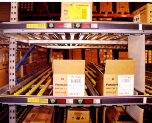
Die neue, durch KDL installierte Pick-to-Light-Anlage unterstützt die Kommissionierer bei ihrer Tätigkeit durch die Anzeige mehrerer Farben
