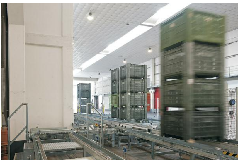
Neben der automatischen Lagertechnik bedient man sich bei Texel der Fördertechnik für den Transport mehrfach gestapelter Großkisten
