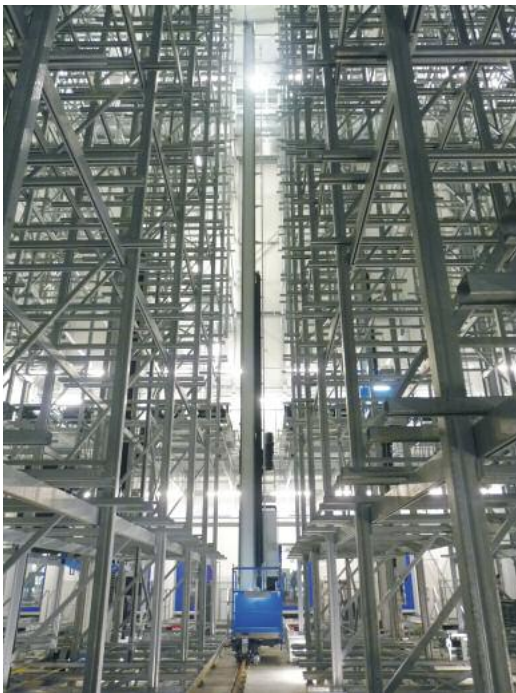
Automatisches Regalbediengeräte bei Mivor kurz vor der Inbetriebnahme
