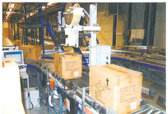
Ein automatischer Etikettenapplikator versieht die fertig gepackten Kartonsendungen mit einem Versandlabel
