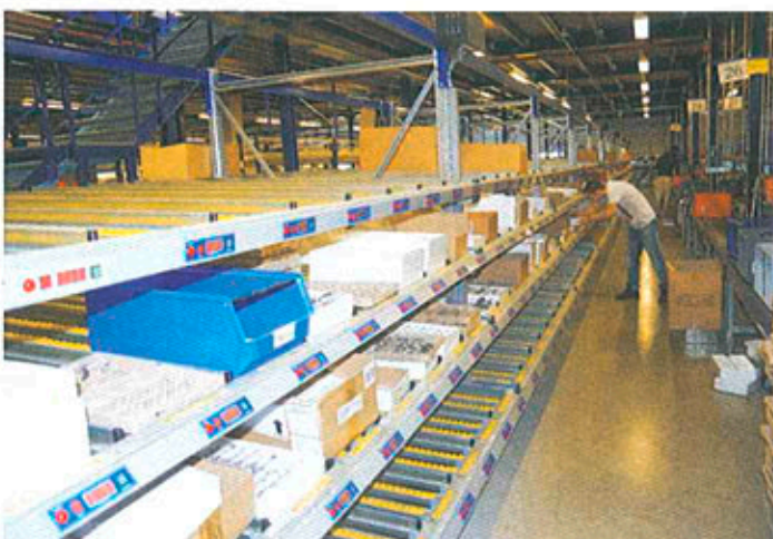
Pick-by-Light-Anlage im manuellen Lager: Die verschiedenen Lagerzonen werden durch das KDL-WOS synchronisiert
