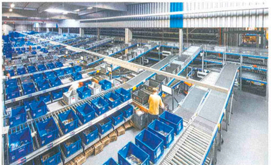
Kommissionierbereich in der Vorzone des automatischen Kleinteilelagers im Fossil-Logistikzentrum. In Spitzenzeiten wird das Kommissionierteam personell aufgestockt
