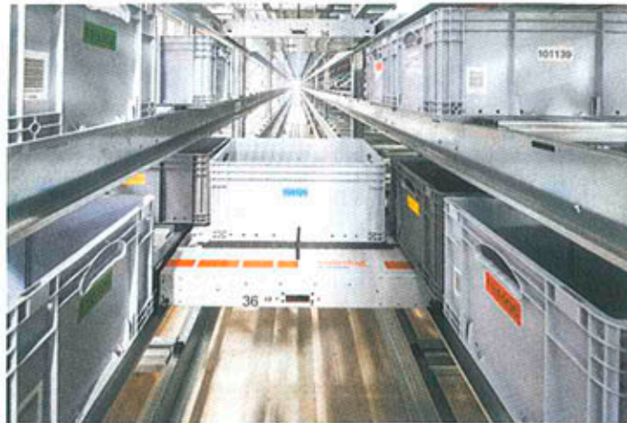
Das automatische Kleinteilelager mit 70 m langen Gassen wird durch 36 Smartcarrier-Shuttles von Swisslog bedient
