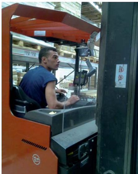
Papierlos kommissionieren: Alle Stapler sind mit Datenfunk-Terminals und Scannern ausgestattet
